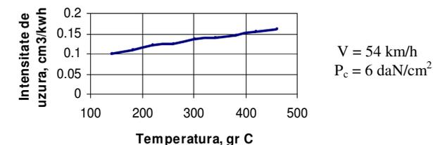
Nota: Caracteristicile de frecare s-au determinat la scara mica, pe epruvete.
